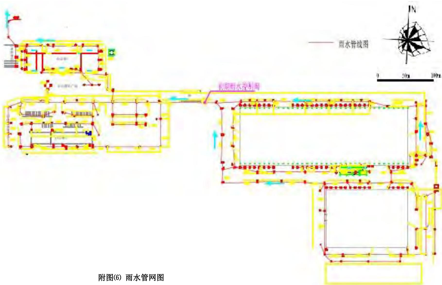
附图(6) 雨水管网图
