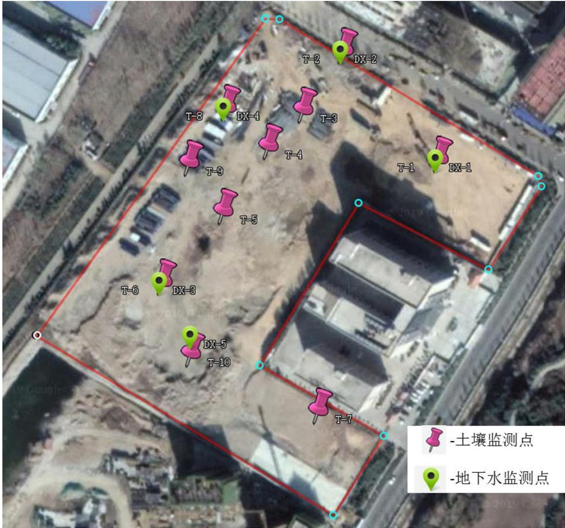
图 5-1 该项目场地土壤、地下水监测布点图
